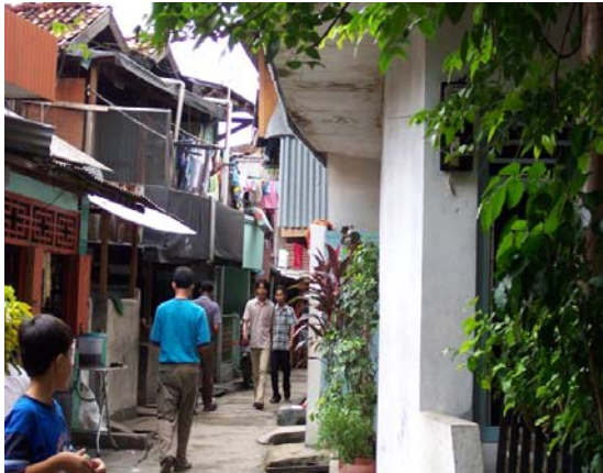
Gambar . 3. Bata separuh badan di lantai bawah dan triplek/kayu di lantai atas
